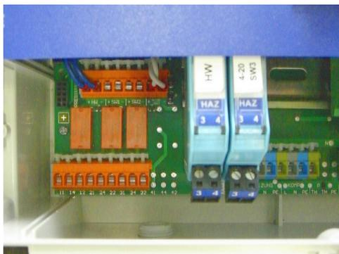
Abb. 2 Stück Zenerbarrieren in 2-Pumpen
